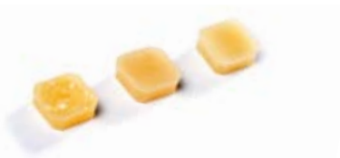
Míra lesku u nevyleštěného kompozitu. Levý vzorek je G-ænial Universal Flo
