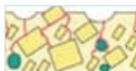
Mechanická zátěž se soustředí na povrchové póry, což vede k šíření prasklin.
